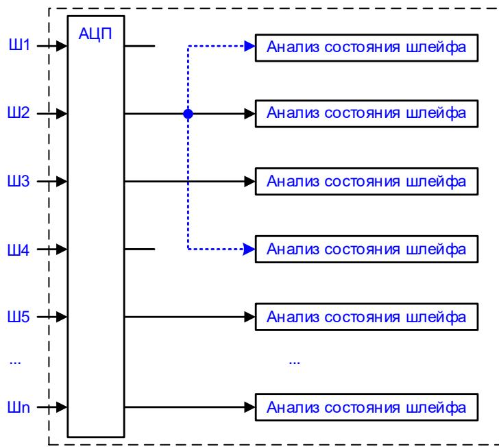
На рисунке приведен пример алгоритма копирования значений АЦП. Синими пунктирными линиями показаны каналы копирования значений АЦП. При этом собственные значения АЦП для таких шлейфов остаются невостребованными (Ш1, Ш4 на рисунке), а состояние таких шлейфов никак не контролируется. Результат работы алгоритма копирования получится следующим:  $A_{ЦП_{Ш1}} = A_{ЦП_{Ш2}} = A_{ЦП_{Ш4}}$ . Дальнейший анализ состояния шлейфов осуществляется как описано в п.5.3.1.
