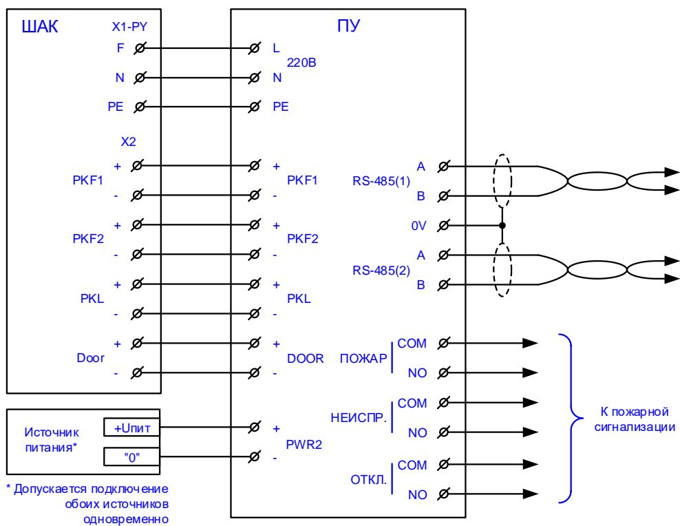
*Схемы подключения пожарных шлейфов*
