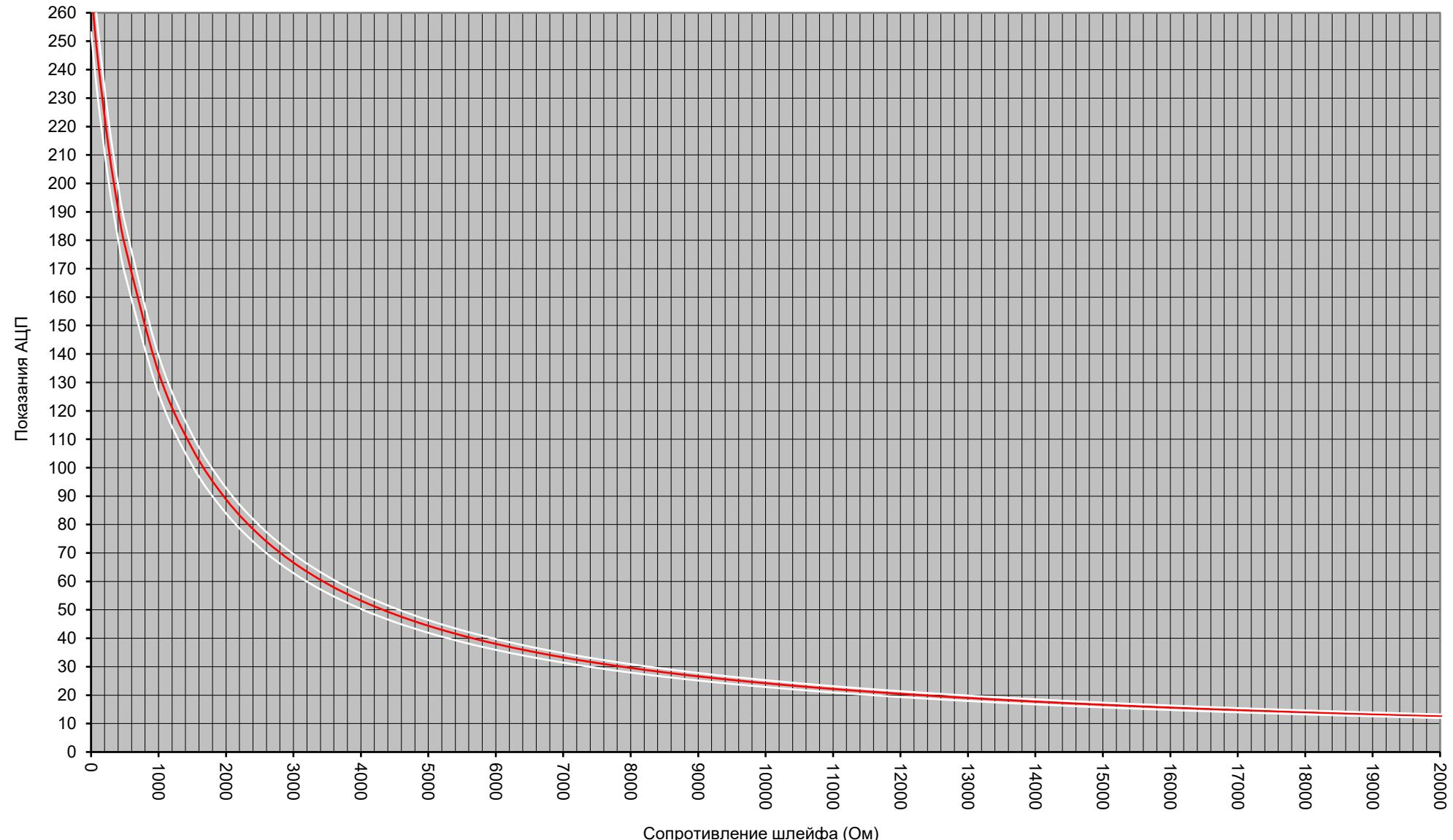
Зависимость показаний АЦП от сопротивления устройства с учетом погрешности измерения
