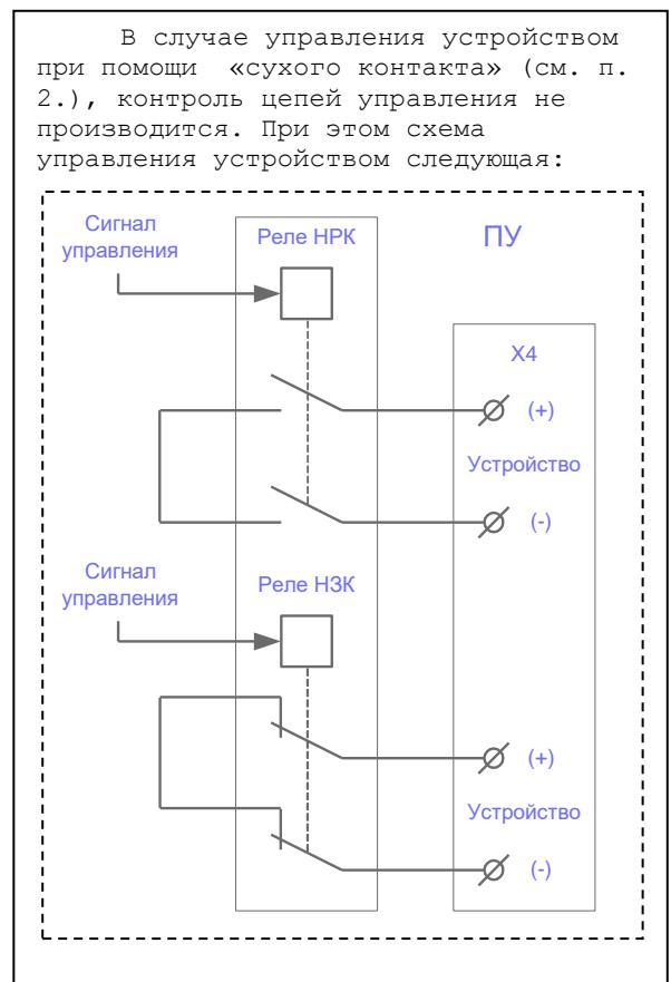
В отсутствие команды на включение устройства, реле выключено, и цепи управления устройством подключены к коммутатору. В этом режиме происходит контроль исправности цепи управления, при этом контролирующее напряжение не превышает 5,0 В, а ток ограничен 1,0 мА. При включении реле схема контроля отключается и в цепи управления подается напряжение питания устройства. Напряжение питания устройства подается от внешнего источника питания.
