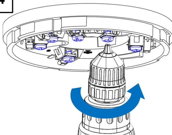
Обеспечьте затяжку винтов на клеммах с усилием не превышающим **1,8 Н/м**
