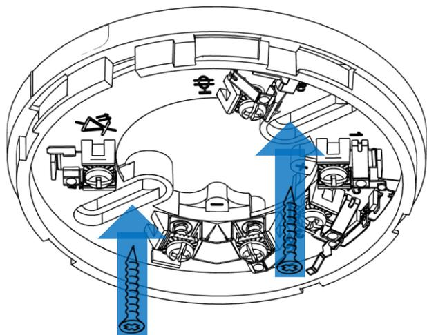
Закрепите базу на ровной поверхности и заведите провода внутрь корпуса базы
