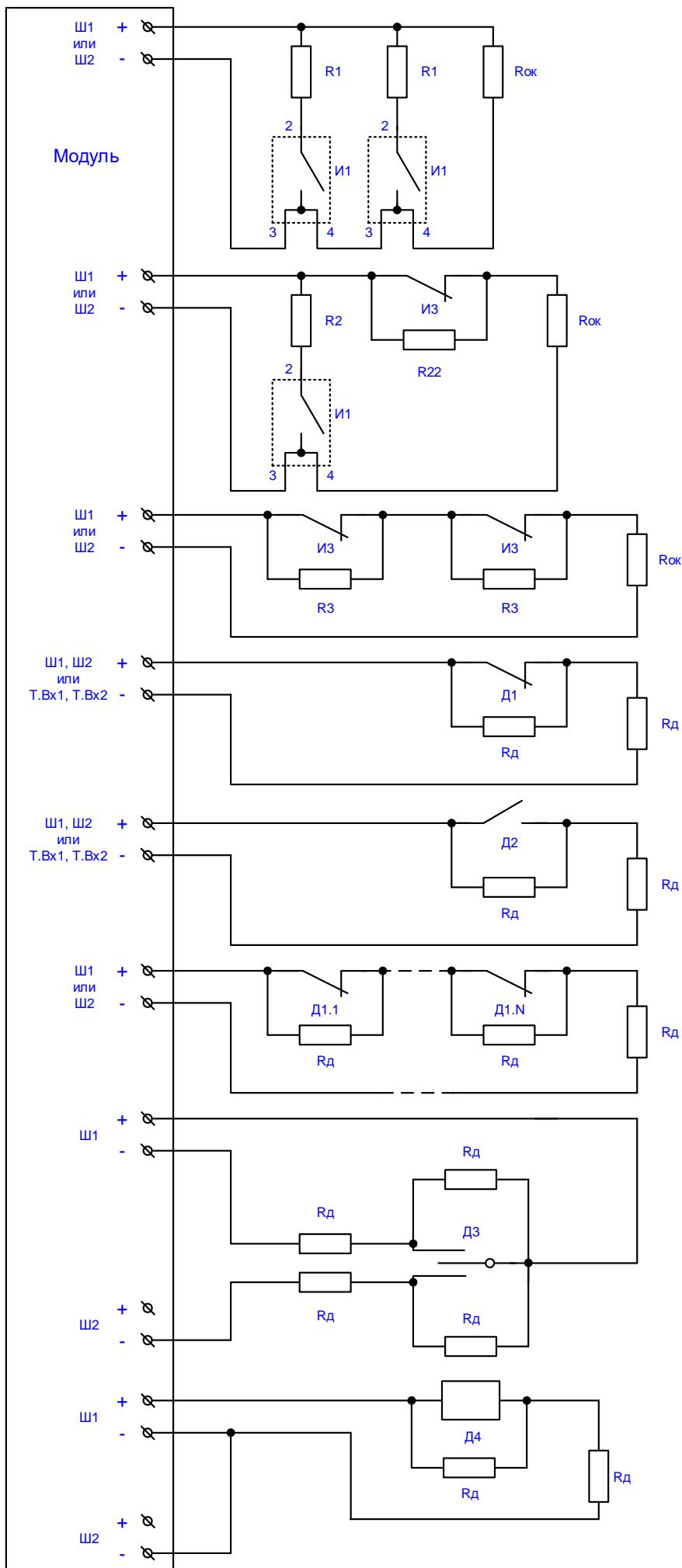
**Шлейф пожарный тип 1**(с определением двойной сработки)
