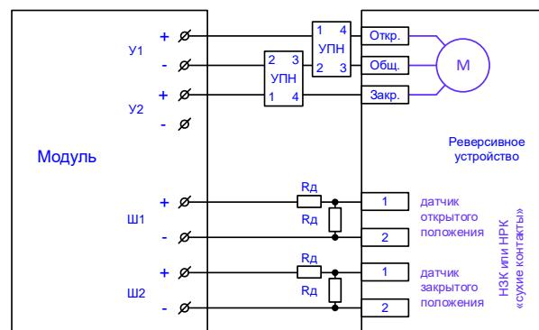
Rd – резисторы 4,7 кОм, 0,25 Вт установить на клеммах привода
