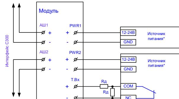
\* Допускается подключение как одного источника питания, так и обоих источников одновременно
