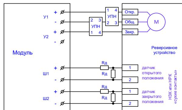
Rд – резисторы 4,7 кОм, 0,25 Вт установить на клеммах привода
