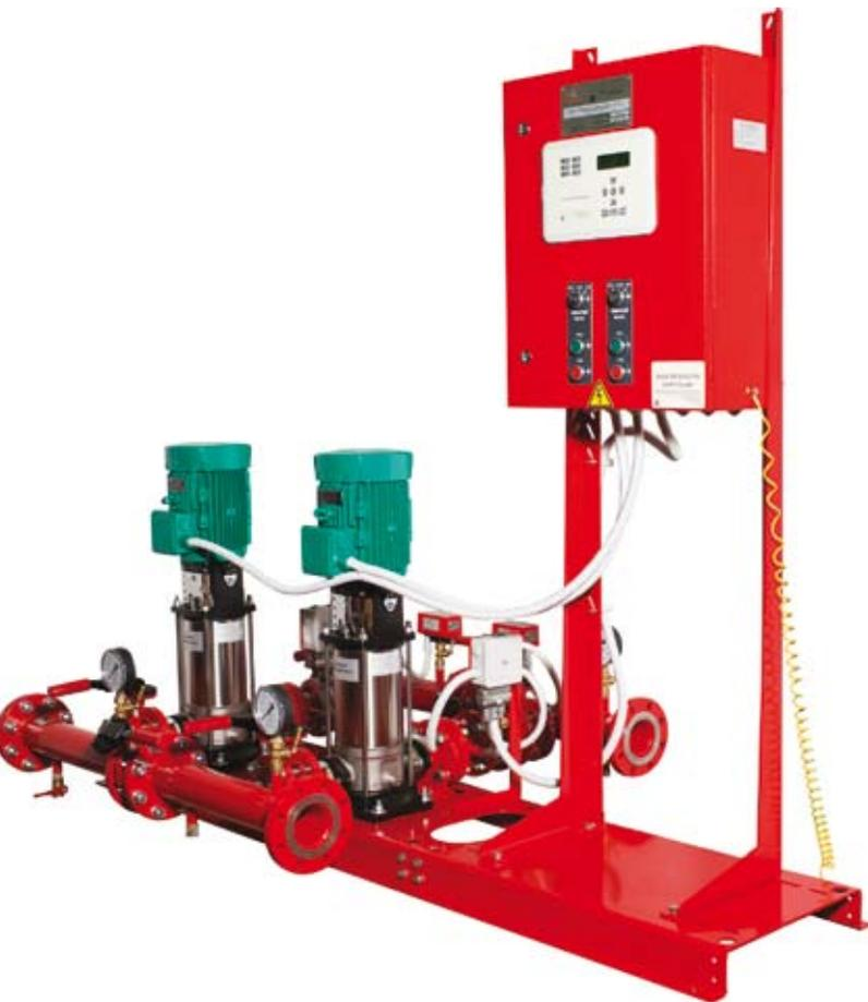
Пуск насосов пожаротушения осуществляется по сигналу «Пожар» от сигнализаторов давления на узлах управления либо от сигнализаторов давления на напорном коллекторе (соединённых по логической схеме «ИЛИ»), либо по сигналу от СПЖ или зоны контроля пожарной сигнализации, в зависимости от вида установки водяного пожаротушения. При этом запуск насосов пожаротушения осуществляется после автоматической проверки давления в системе. При достаточном давлении пуск насосов автоматически отменяется.
