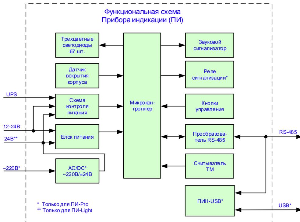
В сети интерфейса RS-485 передача роли «ведущего» производится по методу «маркерного кольца», поэтому в сети нет прибора, единолично исполняющего роль ведущего. Сеть работоспособна при любом количестве приборов в сети.
