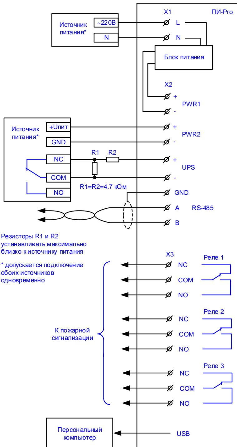
Схема подключения ПИ-Pro
