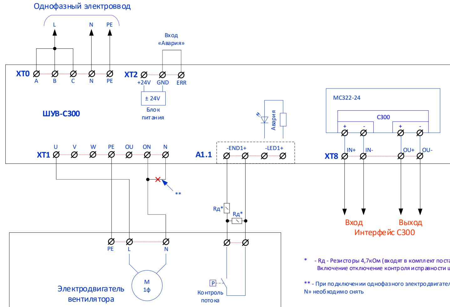
Схема подключения электрического воздухонагревателя для ШУВ-С300 +ТЭН:
