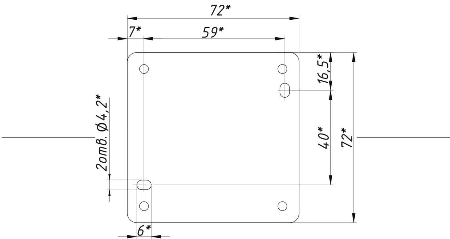
Рисунок 1. Установочные размеры корпуса УВАП.
